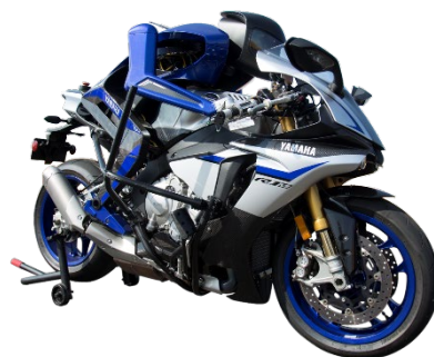
MOTOBOT ヒト型自律ライディングロボット 低速 - 高速走行可能
